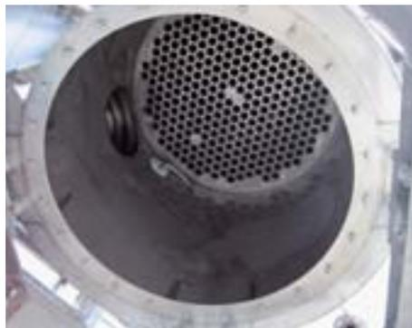
Fallfilm-Wärmetauscher von unten
